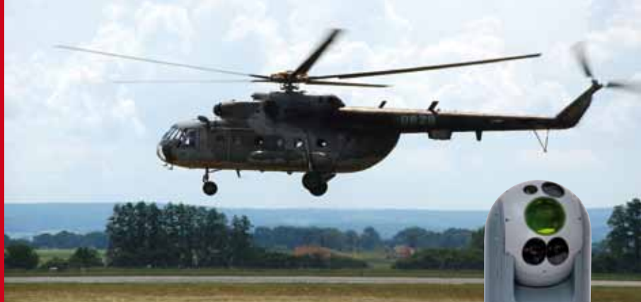
Vrtulník Mi-17 při letové zkoušce na katedře vyvíjené inerciálně stabilizované kamerové hlavice (květen 2011, letecké základna v Pardubicích).
